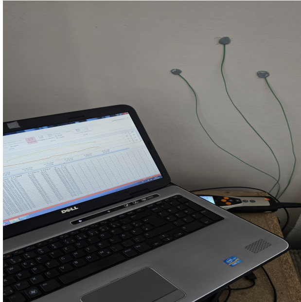
Messaufbau: Testo-Messgerät, Sensoren und kontinuierliche Computeraufzeichnung an der Messstelle.
